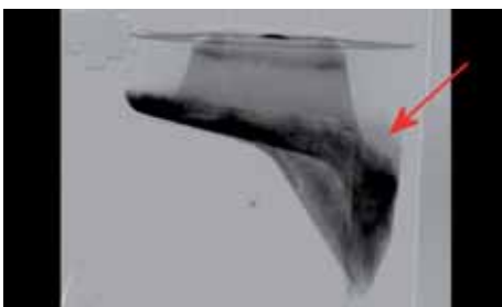
Abb. 4: Ausstrom aus dem Reservoir aus lateraler Richtung; roter Pfeil zeigt wandnahes Rezirkulationsgebiet am Auslaufkonus.
