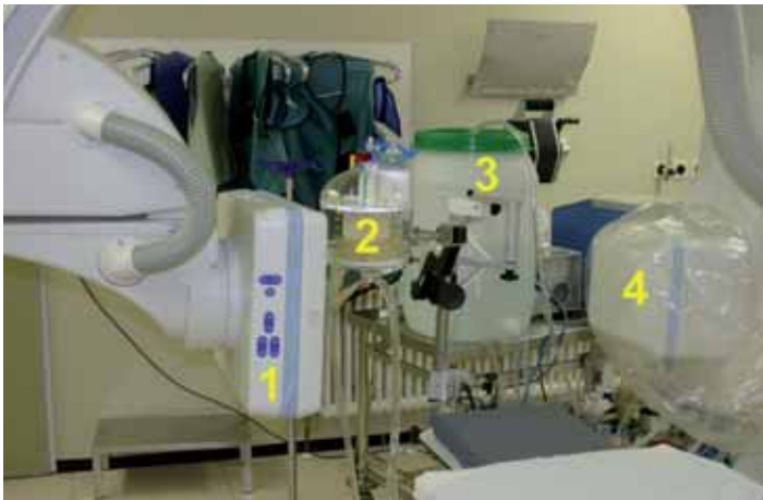
Abb. 2: Röntgendurchleuchtung des Reservoirs aus sagittaler Richtung: 1: digitaler Bildaufnehmer, 2: venöses Reservoir, 3: montierter Perfusionskreislauf auf mobilem Wagen, 4: Röntgenröhre
