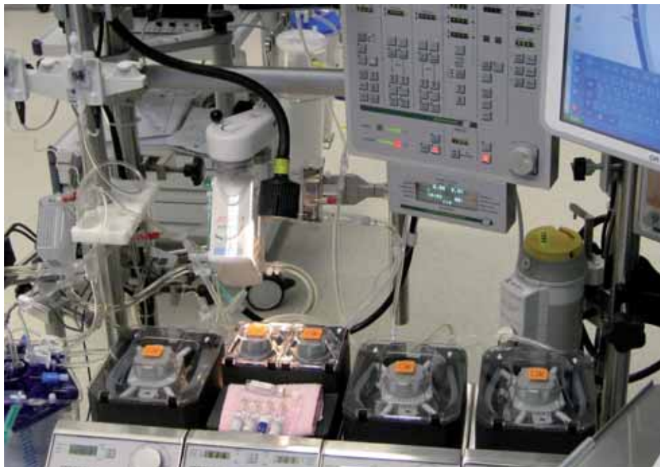
Abb. 2: Platzierung des Oxygenators an der HLM
