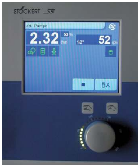
Abb. 9: Stöckert S5: Hoher Informationsgehalt bei guter Übersichtlichkeit durch selbsterklärende Piktogramme. Ob die Displays dem rauen Klinikalltag standhalten, wird erst der Langzeiteinsatz zeigen.
