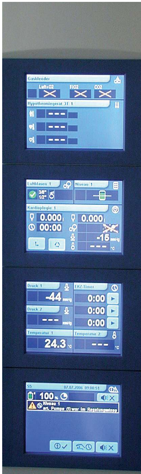
Abb. 8: Stöckert S5: Die Universalmodule sind auch im laufenden Betrieb beliebig austauschbar, angezeigte Messwerte verschwinden jedoch während des Programmiervorgangs. (Foto: Kardiotechnik Cottbus)
