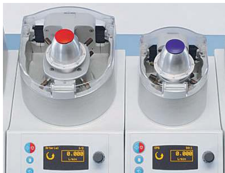
Abb. 6: Terumo System 1: Der kleine Drehregler ist nicht für den ständigen Gebrauch bestimmt: Die Bedienung der Pumpen erfolgt über den Touchscreen. (Foto: Terumo)
