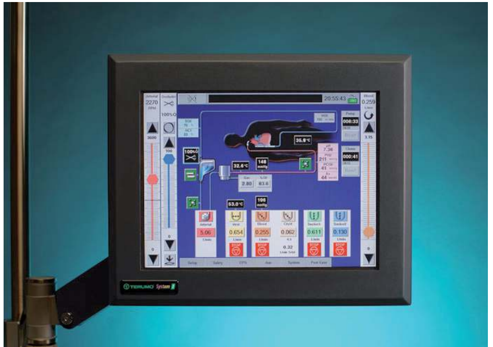
Abb. 5: Terumo System 1: Alle Funktionen werden über einen Bildschirm gesteuert. Dieses gut gedachte Konzept zeigte jedoch noch einige Schwächen. (Foto: Terumo)
