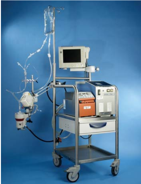
Abb. 1: Das portable Life-Support-System (MECC-LSS), wie es bei uns sowohl für Akutinterventionen als auch in der Routine für aortokoronare Bypassoperationen eingesetzt wird.
