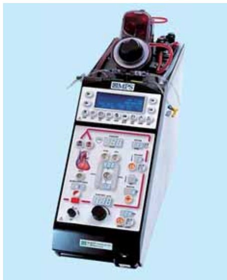
Abb. 2: Das Myokardprotektionssystem MPS2. Übersichtlicheres Display, weiter verbesserte Genauigkeit in der Kontrolle der Pumpenkammern, volumenreduzierter Modus für den Einsatz in der Kinderherzchirurgie und pulsatile Betrieb sind die wesentlichen Änderungen im Vergleich zum Vorgängermodell.
