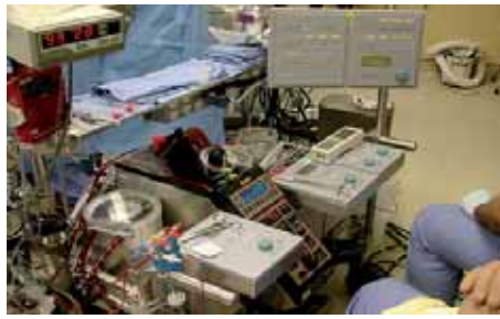
Abb. 1: Das Myokardprotektionssystem MPS. Vier atraumatisch arbeitende Kolbenpumpen in einem Gehäuse, kombiniert mit sechs automatischen Schlauchklemmen, fünf Druckwandlern, Füllstands- und Luftblasensensor sowie Temperatursonden, ergeben eine dem natürlichen Herzen nachempfundene Pumpereinheit zur hochgenauen Steuerung der Myokardprotektion. Im automatischen Betrieb reagiert das System selbsttätig auf den koronaren Widerstand.
